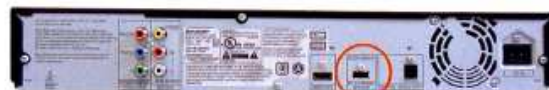
O conector USB ajuda na tarefa de ver uma segunda imagem no canto da tela com o filme em andamento
